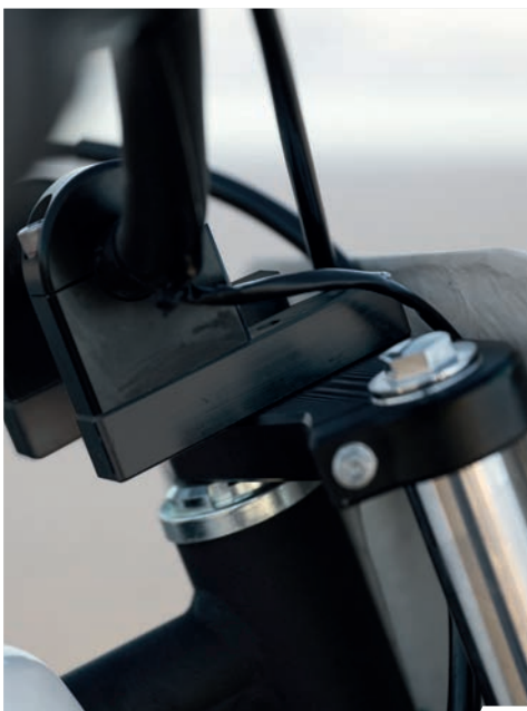
KIT RÉGLAGE GUIDON ARRIÈRE POUR ENFANT LOWER BAR MOUNT ATTACHMENT (DESIGNED FOR YOUTH RIDERS)
